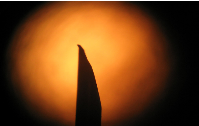
Foto 21: Aguja nueva, de calidad inaceptable.
