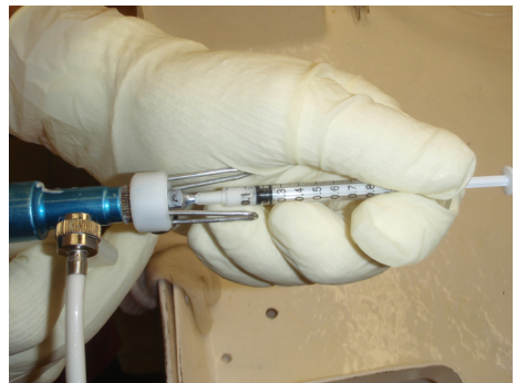
Foto 6: Calibración usando una jeringa de 1 ml.
